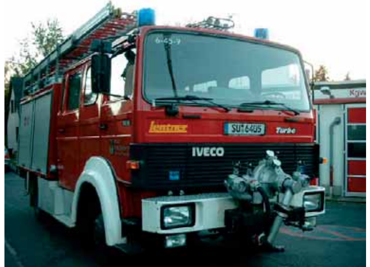
Wasserentnahme aus dem Tank nach dem Umbau
