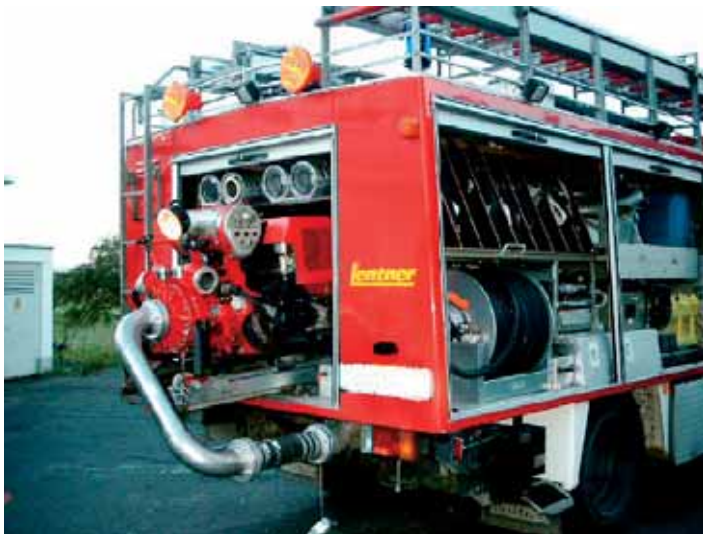
Wasserentnahme vor dem erneuten Umbau
